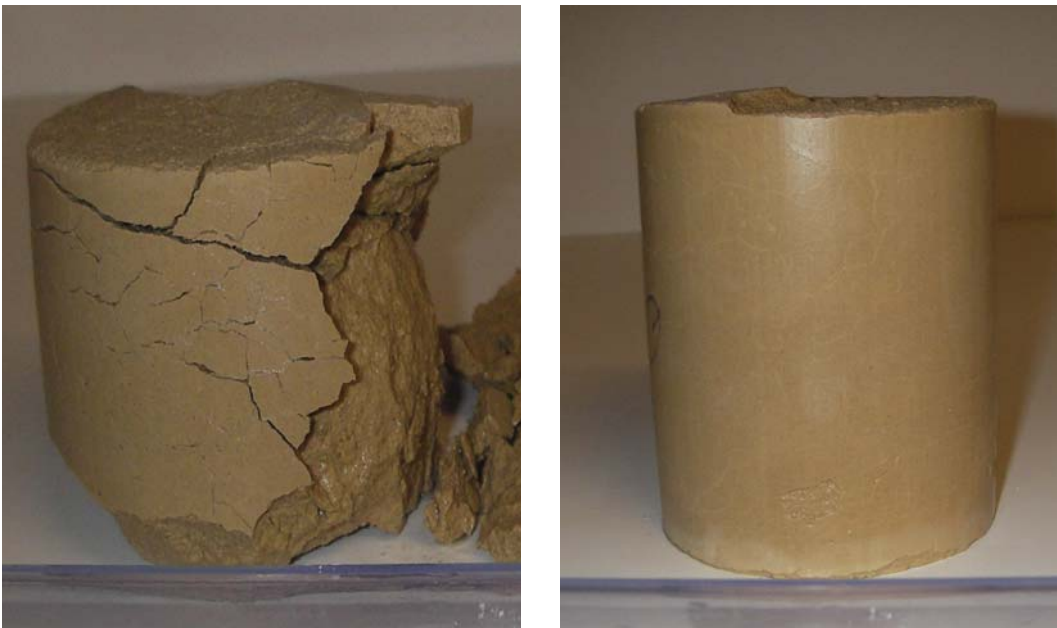
Abb. 7: Prüfkörper eines nicht frostbeständigen und eines frostbeständigen Hinterfüllbaustoffs nach der Prüfung gemäß DIN EN 12371
