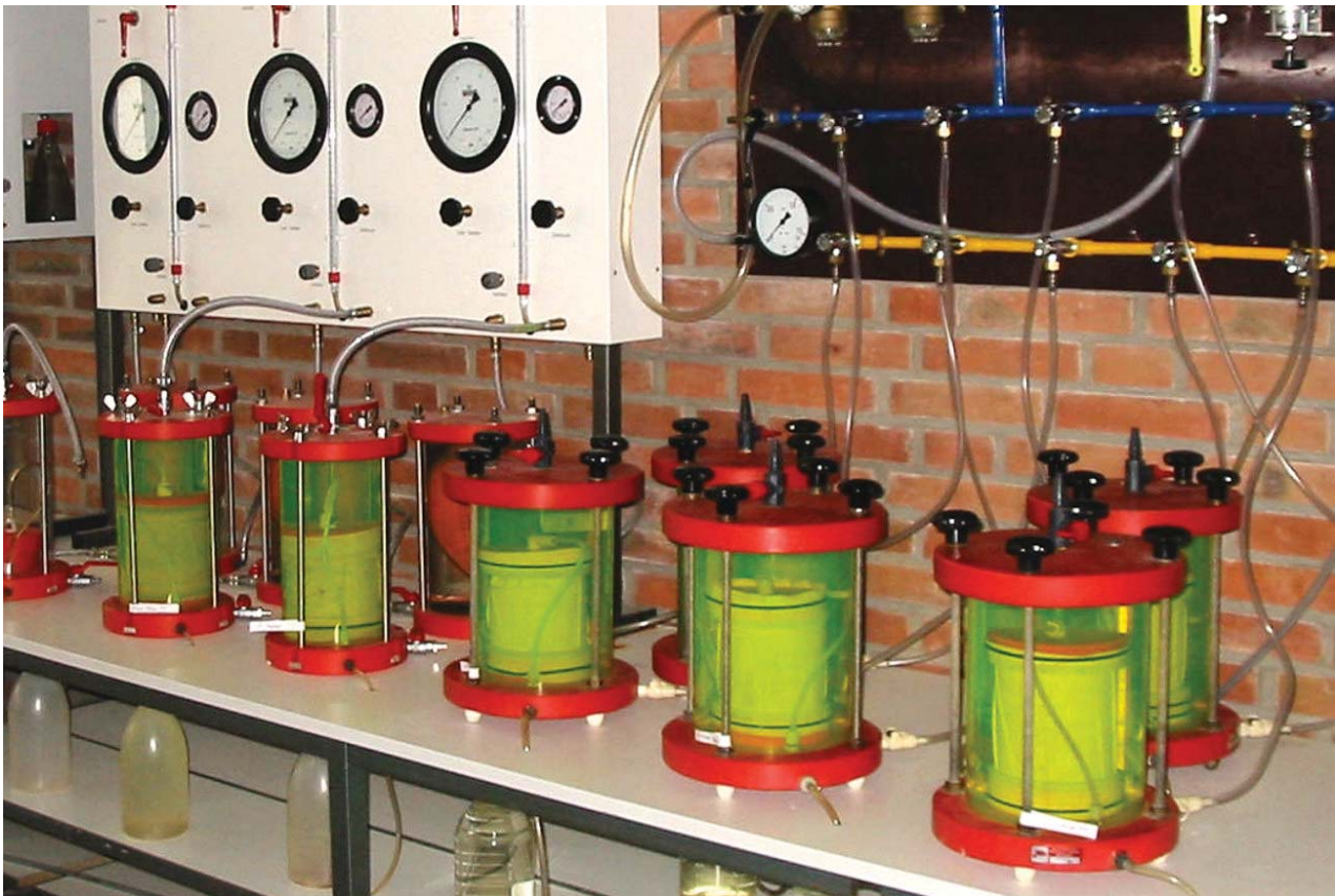
Abb. 11: Prüfstand für Durchlässigkeitsuntersuchungen mit Triaxialzellen
